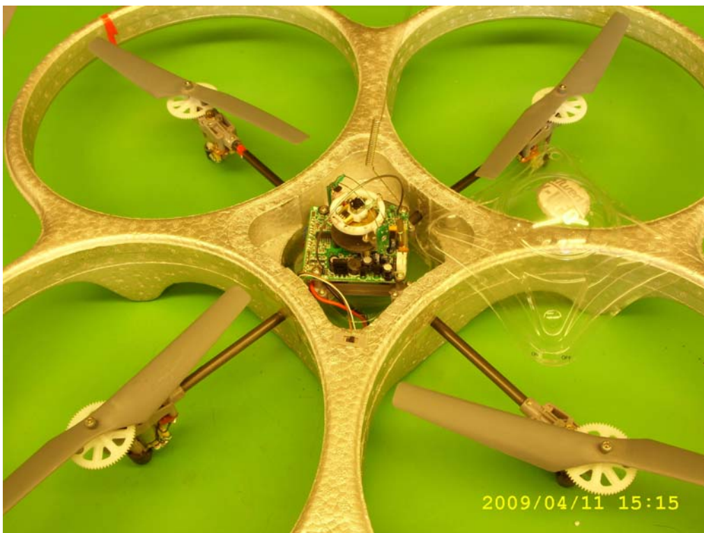
Fig. 2. SwissGyro montiert mit Überrollbügel, Haube mit EPP-Schutz
