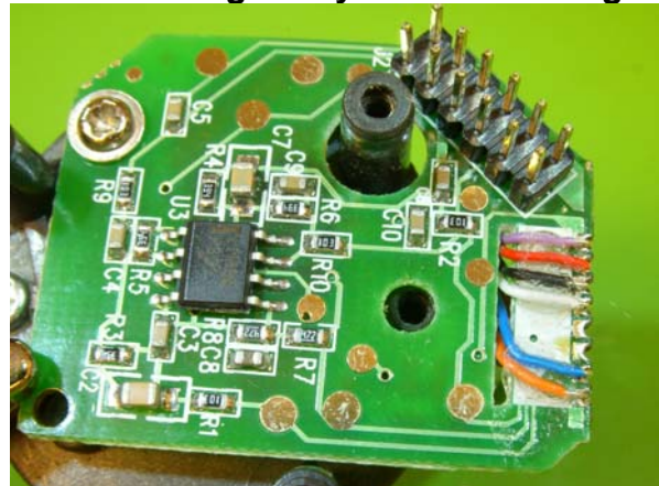
Fig. 8. Lötack auftragen und dann löten. Lötstellen mit Mikroskop auf Kurzschluss kontrollieren. Gegebenfalls nachlöten.
