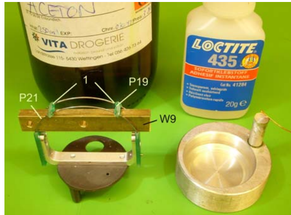
Fig. 13. Bügel-Vormontage auf einer Gabel: Reinigen mit Aceton, mit Lehre W9 beide P19 ausrichten und mit Sekundenkleber bei (1) fixieren.
