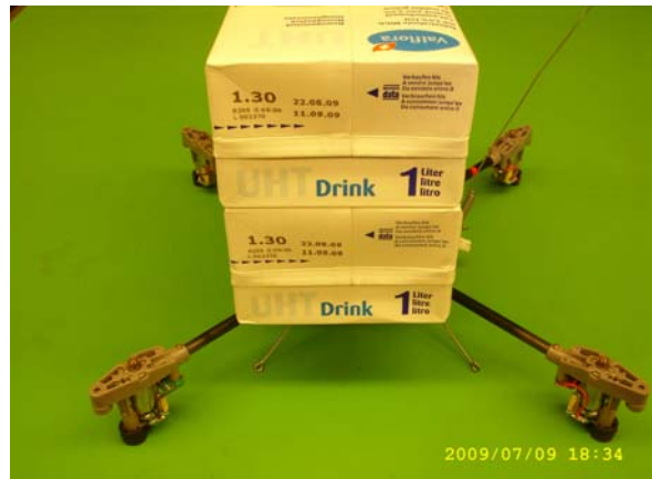
Fig. 13. Bei einer Belastung von 2 kg senkt sich das Fahrgestell soweit ab, dass der Batteriehalter den Boden berührt.
