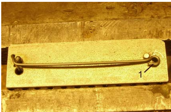
Fig. 6. Draht (1) um Zapfen (2) biegen und bei (3) bündig abschneiden
