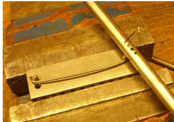
Fig. 7. Hebel (1) einstecken und im Uhrzeigersinn 270 Grad drehen
