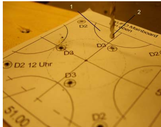
Fig. 14. Falls kein Locheisen zur Verfügung stehen, können die Bohrungen notfalls auch mit Spiralbohrer gefertigt werden.
