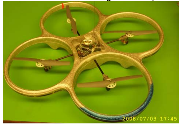
Fig. 18. Flugbereites X-UFO mit SwissGyro - Windstilles Fluggelände von mindestens 5x5x3 m aufsuchen - Abheben, auf 50 cm Höhe steigen - Trimmungen auf Schwebflug einstellen - Genussvoll fliegen lernen
