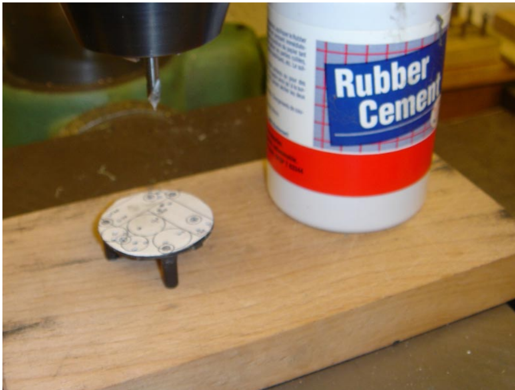
Schnittmuster auf Kreisel-Unterteil aufkleben und mit Zentrierbohrer und 1mm Spiralbohrer bearbeiten
